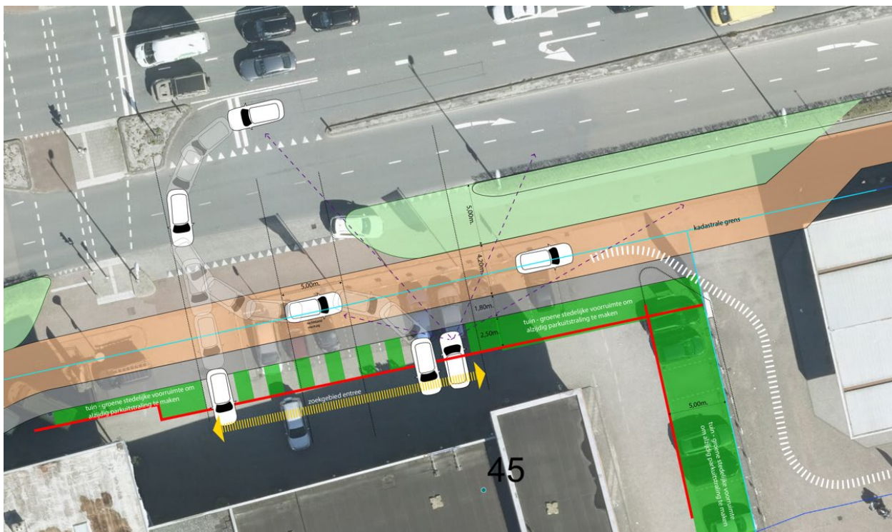
Kaart met de dimensies die nodig zijn om veilig in en uit te rijden van de parkeervoorziening van Hogeweg 45.
